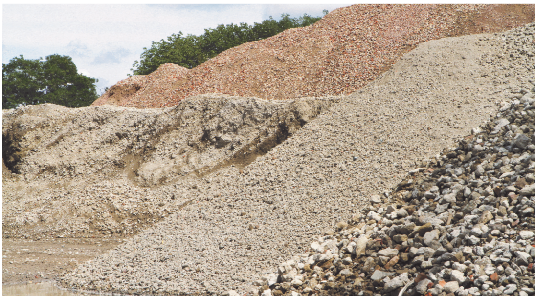
Blootstelling van betongranulaten aan de lucht bevordert de CO 2 -opname © BBRI-CSTC-WTCB
